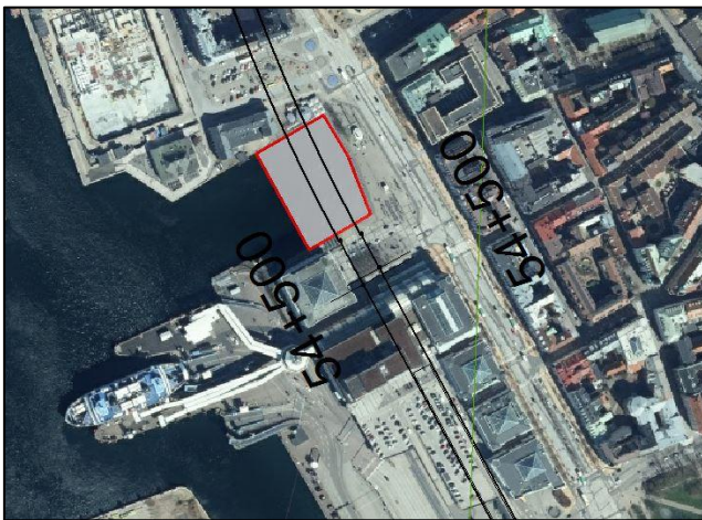
Figur 15. Detalj över Stationsläget vid Kungstorget, grått området markerat är bedömd omfattning av uppfyllnad i hamnbassäng.
