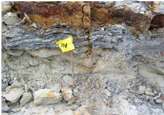
Fig. 7. Hård rödbrun järnkarbonatcementerad sandsten underlagrad av mörkgrå mjuk tunnskiktad lera och silt som i sin tur underlagrad av lös-medelhård ljusgrå-gulvit sandsten. Nya polishuset i Helsingborg. Foto: M. Erlström 2004.
