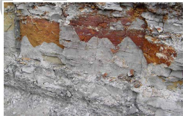
Fig. 8. Ljusgrå finkornig hård ca 0,8 m mäktig sandstensbank. Järnoxidimpregnerade spricktytor. Helsingborgsledet, Nya Polishuset i Helsingborg. Foto: M. Erlström 2004.
