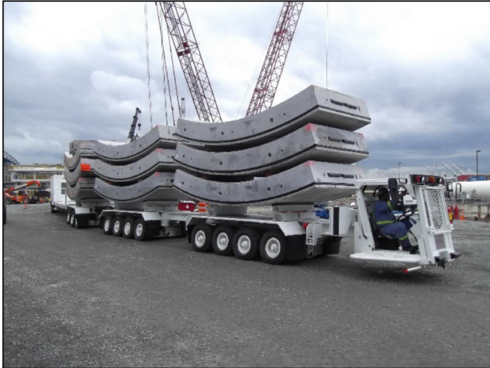
Figur 24. Multi Service Vehicles (MSV). Källa: Amberg, HH – Fast Förbindelse, 2019
